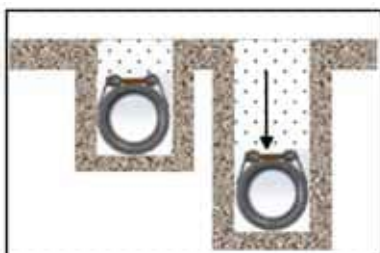
1 Ausreichende Überdeckung mit Wiedereinfüllmaterial
