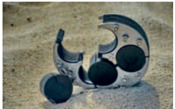
Die bewährte **Zwiebelschnitttechnik** ermöglicht, dass die Kabeldurchmesser stufenlos wählbar sind. Sie müssen lediglich die Anzahl der Gummischichten entfernen, bis der gewünschte Durchmesser erreicht ist.
